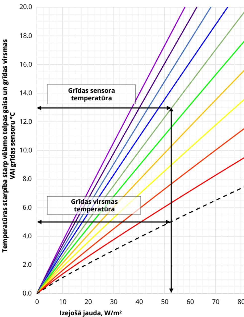
Izmantojot augstāk redzamo grafiku, iegūstam elektriskās grīdas apsildes sistēmas izejošo siltuma jaudu, balstoties uz temperatūras starpību starp vēlamā telpas gaisa temperatūru un grīdas virsmas vai grīdas sensora temperatūru atkarībā no grīdas apdares.
